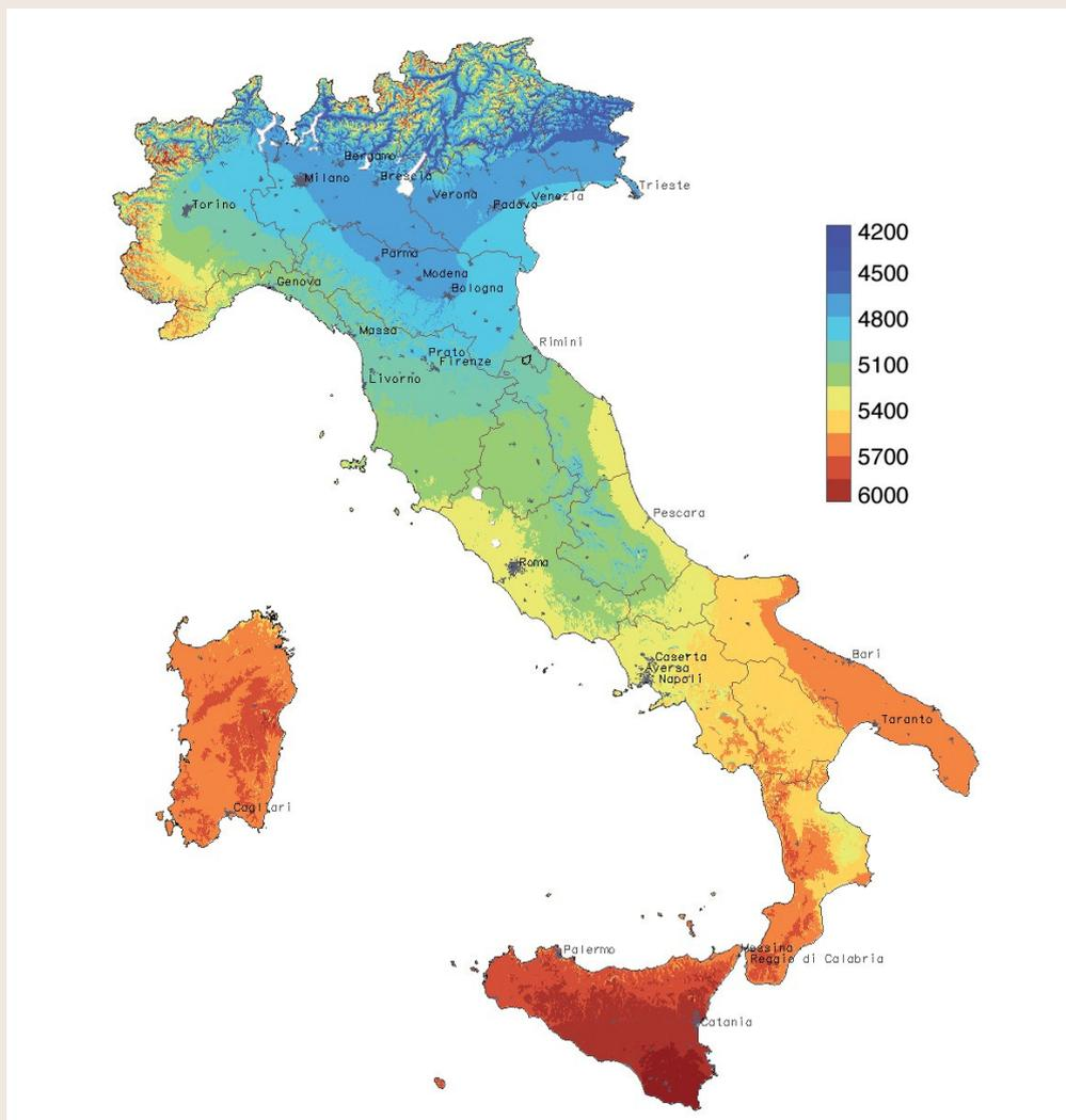
La verniciatura con polveri di CLASSE 2 è caldamente raccomandata per le installazioni nelle zone costiere, in ambienti con elevata umidità, inquinamento e salinità e comunque in tutte le zone caratterizzate da esposizione con valori di Radiazione Solare Media Annua (R.S.A.) superiori ai 5400 MJ/m<sup>2</sup>, evidenziate nella cartina in alto.
